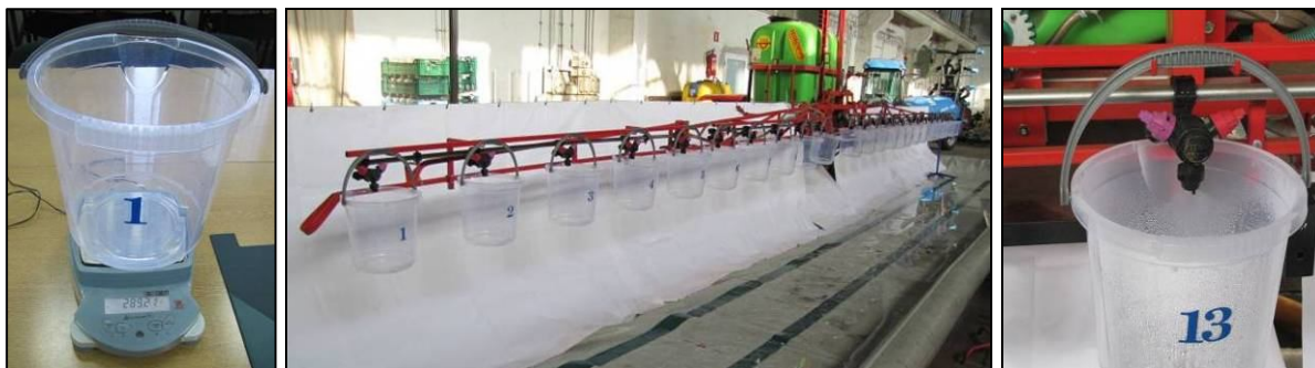
Rys. 1-3. Wiaderka o pojemności 10 l stosowane w metodzie wagowej: ważenie wiaderka, wiaderka na belce opryskiwacza i sposób zawieszenia wiaderka na belce.
