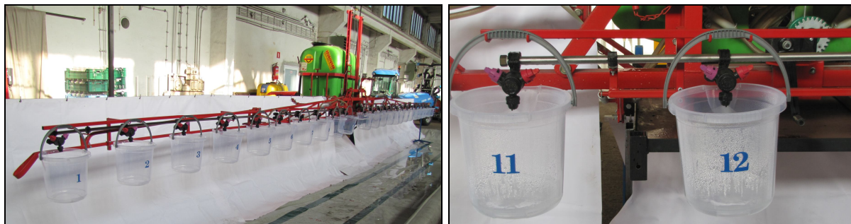
Rys. 5-6. Stelaż do zawieszenia (ponumerowanych) wiader pod badanymi rozpylaczami montowany do belki opryskiwacza.
